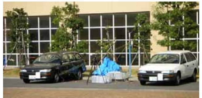
図2 静置比較実験(左:低反射率車, 右:高反射率車)
